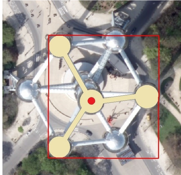
Afbeelding 17: Het Atomium is geregistreerd als een punt aangezien het gedeelte boven 60 m in een rechthoek met een breedte en lengte van minder dan 100 m past. De vlag bovenaan is een afzonderlijk obstakeldeel.
